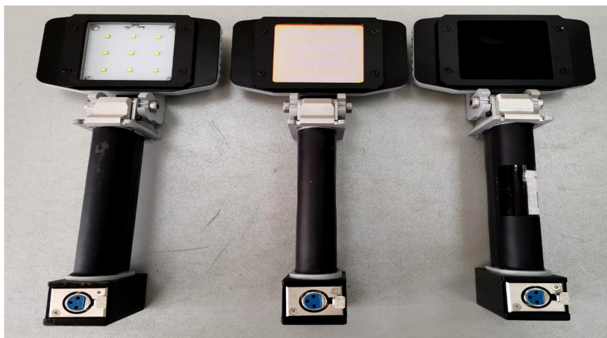
Рис. 2. Модули белого, синего и ультрафиолетового света
